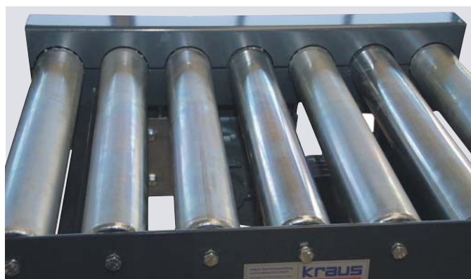
hohe Betriebssicherheit durch geschlossene Kettenschutzabdeckung
